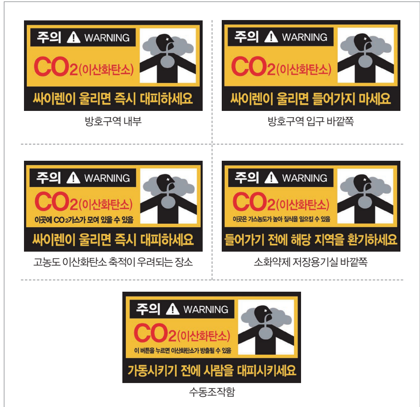
[그림 4] 이산화탄소 소화설비 경고표지와 부착위치
