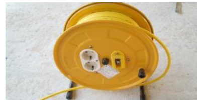
충전부 방호조치 · 누전차단기 설치
