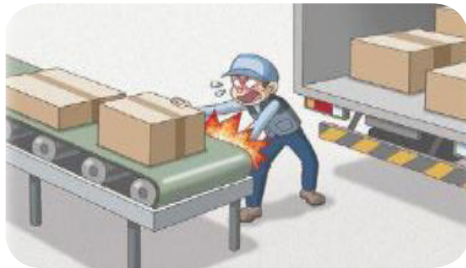
컨베이어를 이용한 물품 분류작업 중 손 부위 끼임
