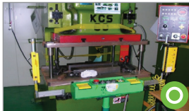
광전자식 방호장치 설치
