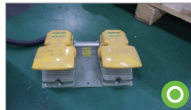
풋 스위치 덮개 설치
