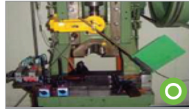
손쳐내기식 방호장치 설치
